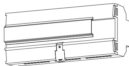
Рисунок 3: Установка MAXinBOX 24 на DIN рейку
