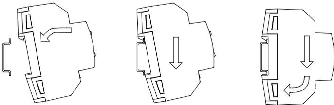
Демонтаж HeatingBOX 230V 8X с DIN рейки:
