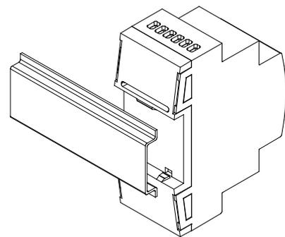
Рисунок 3: Установка HeatingBOX 230V 8X на DIN рейку
