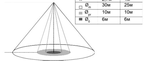
$\varnothing_m$ : Обнаружение движения по касательной. При движении перпендикулярно датчику, зона обнаружения сокращается (смотрите советы по установке).
