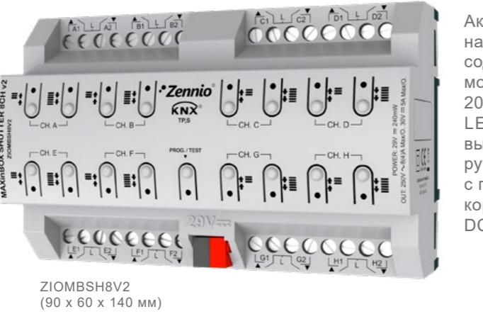
Актуатор для жалюзи на DIN рейку (8 TE), содержит логический модуль, поддерживающий 20 логических функций. LED индикация статуса выходов и возможность ручного управления с помощью кнопок на корпусе. Аксессуары: AC/DC адаптеры для жалюзи.
